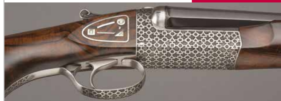
Gravure du fusil Azur Trilogy, avant sertissage des pierres précieuses par le joaillier Tournaire Verney-Carron, années 2010 © Verney-Carron SA / cliché La Clique à Bill
